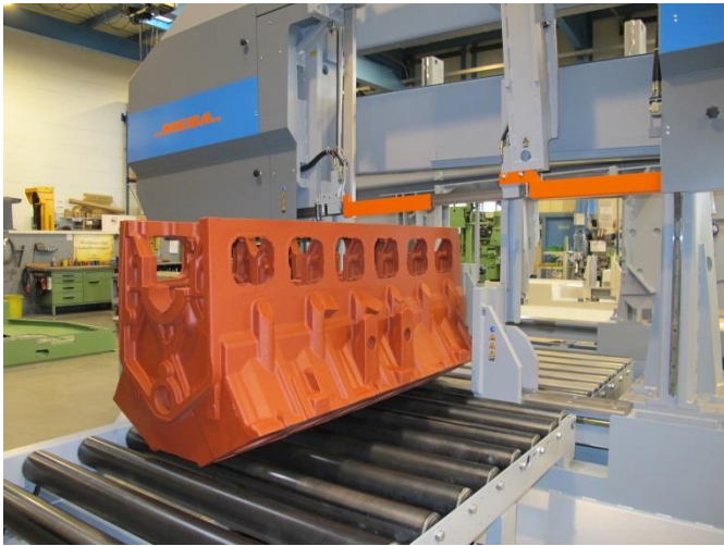
VISTA DE LA SUJECIÓN HIDRÁULICA
